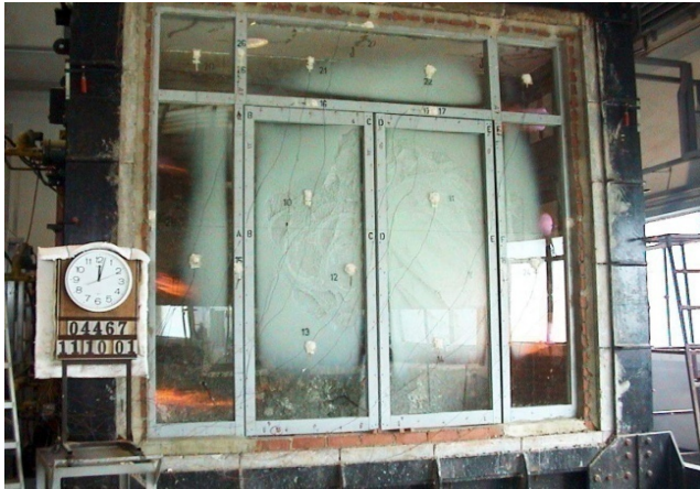
逾千攝氏度防火玻璃門連間隔實火測試
